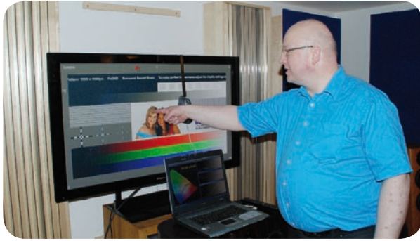
Mit Farbspektrometer und Labor-Software geht der Kalibrator ans Werk. Die Bildparameter werden auf normierte Wiedergabe getrimmt.
